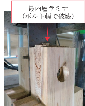
Photo 1 代表的な破壊形式 (Representative Failure Mode)
