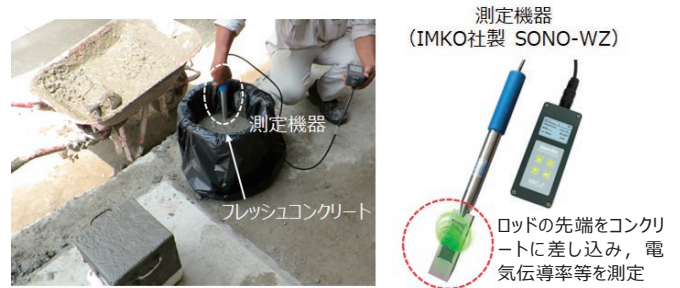
Photo 1 電気伝導率の測定方法 (Measurement Method of Electrical Conductivity)
