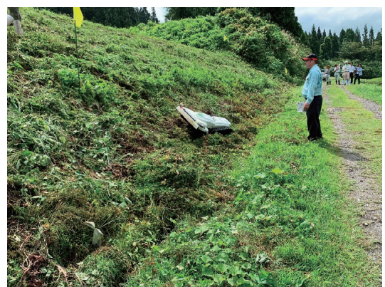
Photo 8 電動リモコン草刈機による除草作業 (Weeding with Electric Remote-Controlled Mower)
