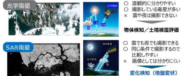
Fig.21 光学衛星と SAR 衛星 (Optical and SAR Satellites)
