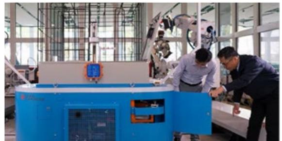
コンクリート床押さえロボットの開発状況
