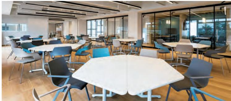
長年にわたり鹿島の社員子弟を育ててきた児童館が閉園。その想いを受け継ぎながら、次世代リーダーを育成する研修所へのコンバージョン計画である。かつての下足エントランスは視線が抜けるよう壁を取り払い、研修の合間に建築やビジネス関連の書籍に触れられるよう配置した本棚でゆるくラウンジとの境界を構築した。天井が低かった研修室部分は、一部スケルトンにすることで開放感を演出。天井の高い旧遊戯室は、カンファレンスホールに改修し、ルーバーを壁と天井に連続して配置しトップライトから落ちる光を強調した。床の木フローリングは、既存無垢材の表面を研磨し、再活用している。旧園庭には、デスクやロングベンチを配置し、アウトドアワークに活用。建物の特長を活かし、各所にかつての素材や設えを残しながら、幅広く社員が交流し、主体的に成長していく場づくりを目指した。
